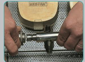
Sistema rápido de desmontaje y montaje del arbol de dispersión.
