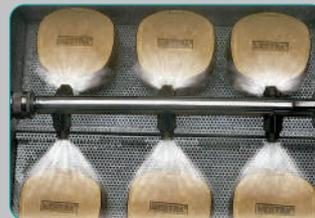
El sistema de lavado por 6 inyectoros de agua a presión nos aseguran un buen escaldado de las mufas y un desencerado perfecto.
