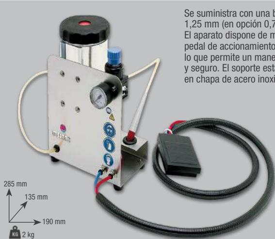
Se suministra con una boquilla de 1,25 mm (en opción 0,75 mm y 1 mm). El aparato dispone de manorreductor, pedal de accionamiento, y manómetro, lo que permite un manejo preciso y seguro. El soporte está construido en chapa de acero inoxidable.
